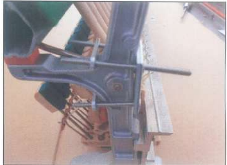
高音部 ブラケット取付前工程
